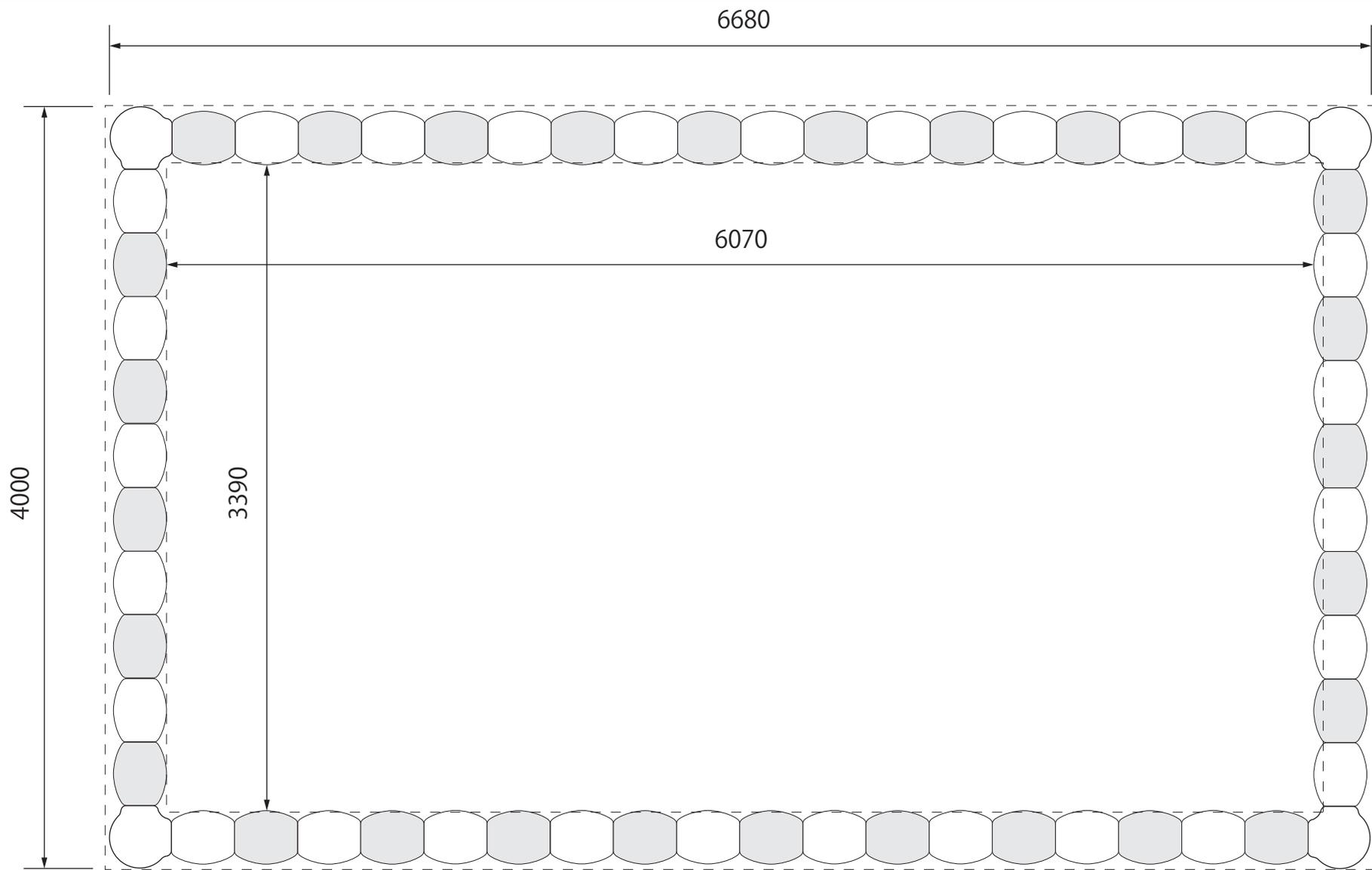
外寸枠 4.0×6.7m 内寸枠 3.4×6.1m
