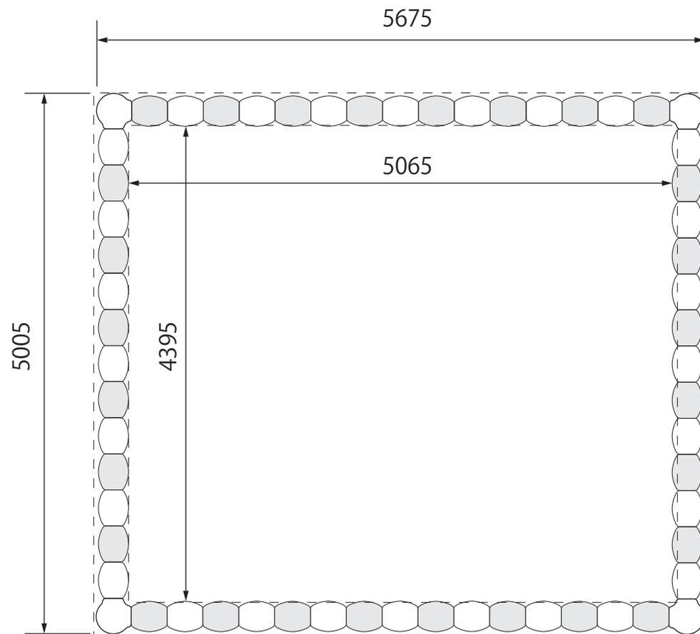
外寸枠 5.0×5.7m 内寸枠 4.4×5.1m
