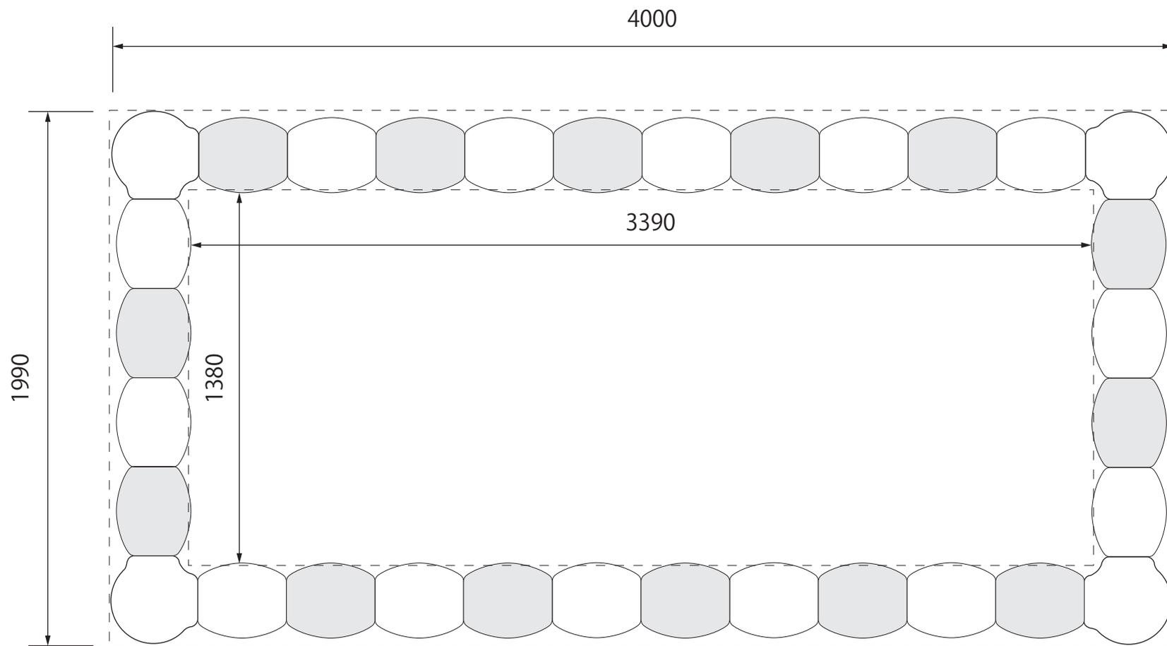
外寸枠 2.0×4.0m 内寸枠 1.4×3.4m
