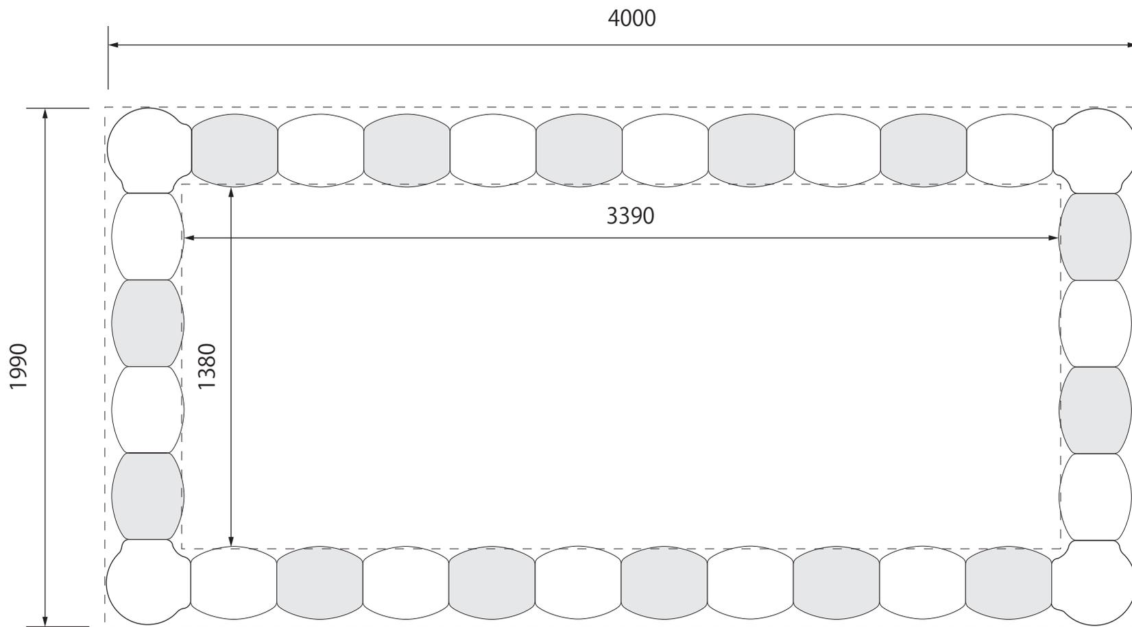
外寸枠 4.0×2.0m 内寸枠 3.4×1.4m
