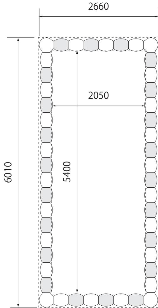
外寸枠 6.0×2.7m 内寸枠 5.4×2.1m
