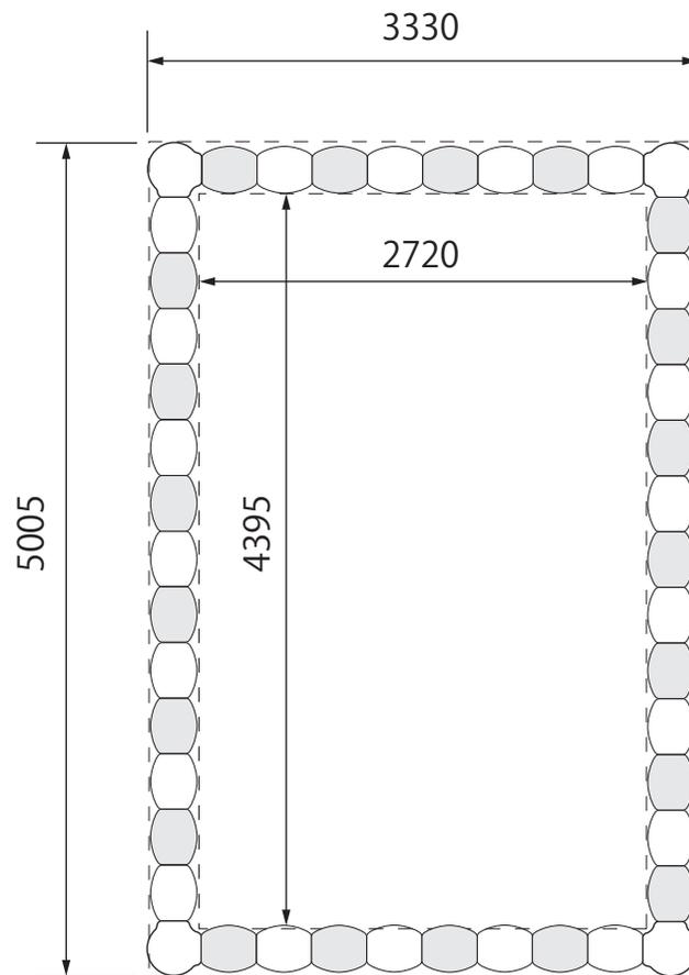
外寸枠 5.0×3.3m 内寸枠 4.4×2.7m
